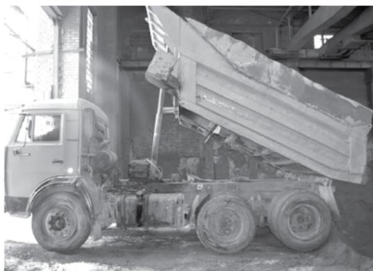
Кварцевый песок доставляется на склад обжигового большегрузным транспортом, а в печь – грейферным краном
